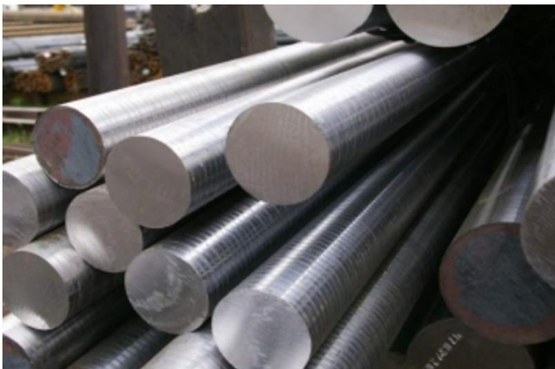
Стальным кругом называется такое изделие, которое представляет собой прут большой длины. При этом такое изделие может обладать достаточно разным диаметром, конкретный вариант которого подбирается в зависимости от стоящей в данном случае перед потребителем задачи.
